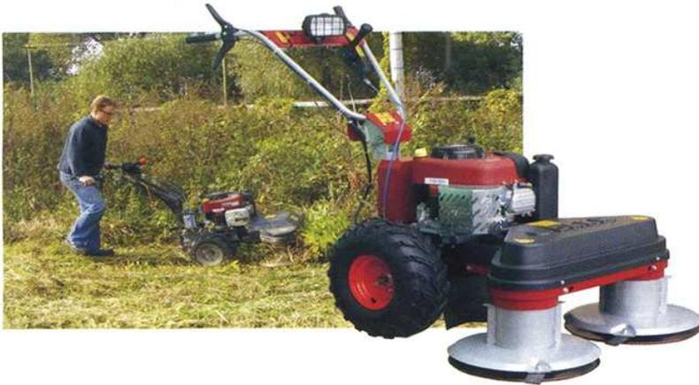
Diese Geräte ist für die tägliche Arbeit auf großen Flächen ausgelegt. Mit dem serienmäßigen Elektrostart können sie schnell und ohne lästiges ziehen des Starterseils loslegen. Während des Einsatz macht das hydrostatische Getriebe die Handbremse und die Entsperrung der Achse das Arbeiten kinderleicht.
