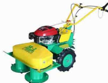
Einachsschlepper mit Trommelmähwerk
